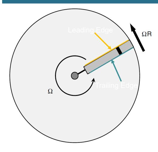
$\Omega$ : propeller angular velocity
